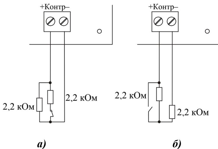
**Рисунок 2. Подключение к БДУ «ГАММА-САТ»:** а) размыкающегося при закрытии двери магнитного контакта, б) замыкающегося при закрытии двери магнитного контакта.
