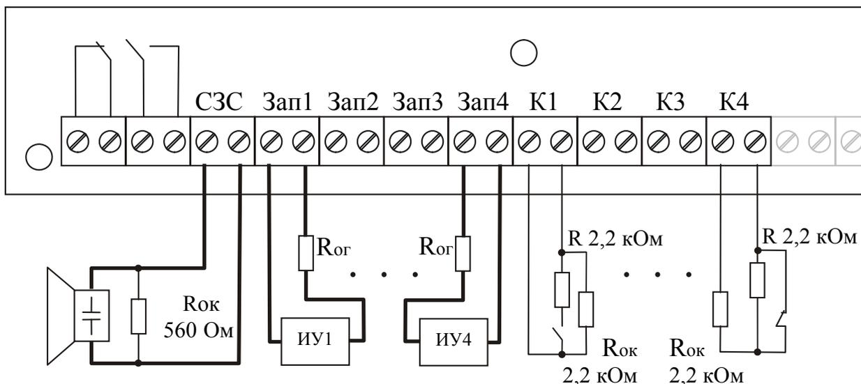
К выходу запуска ППКП «ГАММА-102САТ» допускается подключение параллельно нескольких исполнительных устройств с применением ограничивающих резисторов  $R_{ог}$ :
