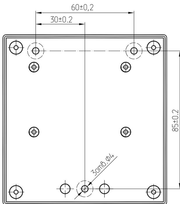
*Рисунок 2. Разметка крепления БДУ*
