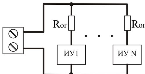
Для выбранного  $N$  (количества исполнительных устройств, подключенных к выходу) и  $I_{иу}$  (ток, необходимый для срабатывания ИУ) сопротивление ограничительного резистора выбирается из соотношения:
