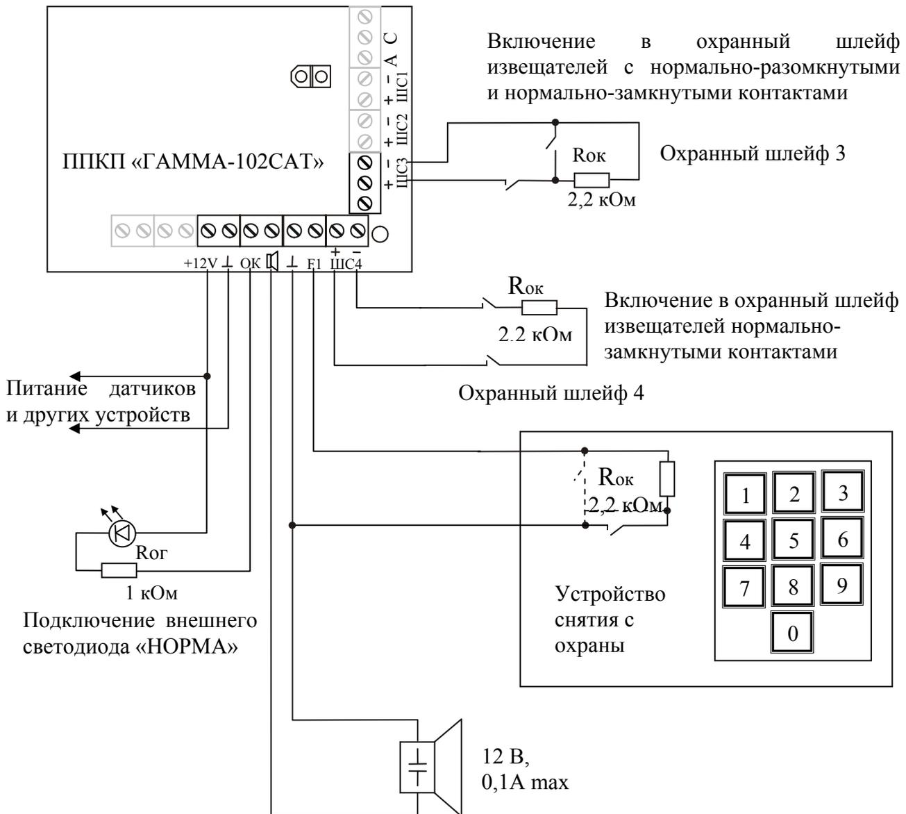
Выходы «ШС3», «ШС4» предназначены для подключения датчиков с номинальным напряжением питания 12В.
